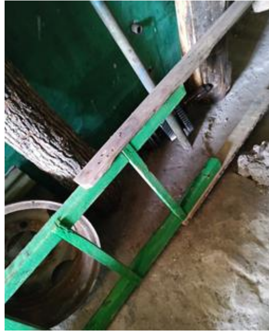
Самодельные деревянные приставные лестницы, сбитые гвоздями, без врезки ступенек в тетивы
